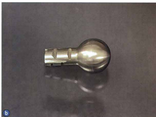
图4 a. Biomet 3i 计算机辅助设计不锈钢球; b. 在转移到主模型舌体部位的参考钢球上制作固位沟
