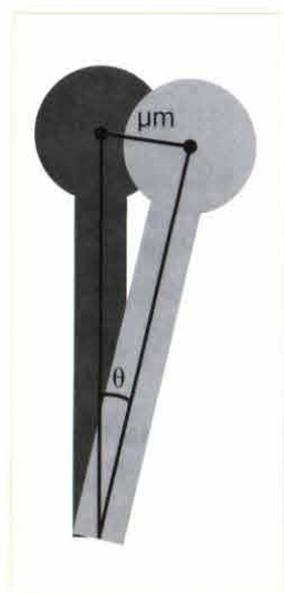
图11 图解种植体替代体放置过程中产生的角度误差,会导致在殆面的误差大于根尖处误差
