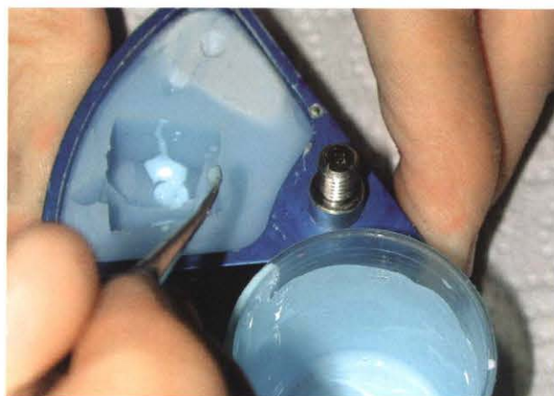
图7 将聚氨基甲酸酯树脂材料缓慢注入硅橡胶印模
