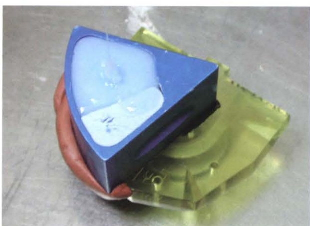
图6 将加成型硅橡胶注入型盒
