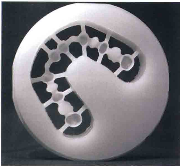
图18 用Al 2 O 3 (100目)在2bar的压力下进行喷砂
