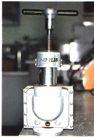
图 29 用压模方法充塞塑料
