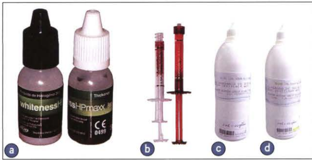
图4 第二部分实验中使用的材料。a. 35%过氧化氢；b. 38%过氧化氢；c. 20%氢氧化钠；d. 7%碳酸氢钠
