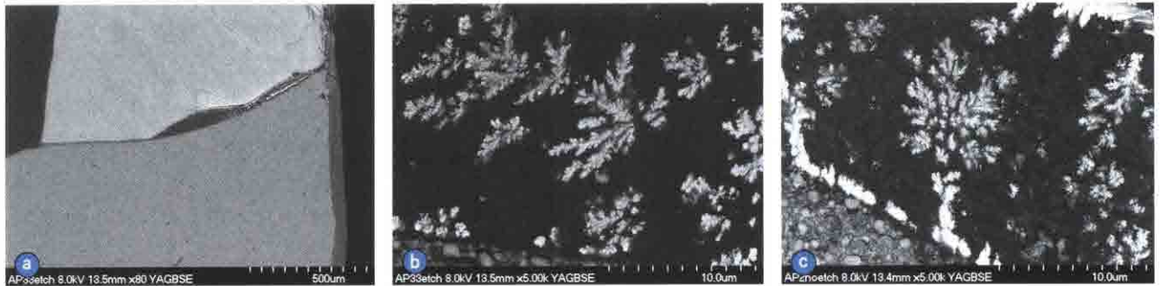
图 3(a-c) 显示 Adper Prompt L-Pop 处理后的牙釉质-复合体界面的黑点 FESEM 图像。(a, b) 酸蚀，热循环标本。(c) 这个标本是非酸蚀或热循环的。注意图(a)是 1 级微渗漏。在酸蚀的(b)和非酸蚀的(c)标本的粘结层都观察到了水草形和网状银沉淀。原始放大倍数：(a)x80, (b)x5 000, (c)x5 000
