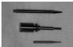
图1 取螺栓钻针及螺丝批
