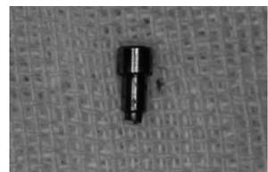
图6 临时基台折断部件
