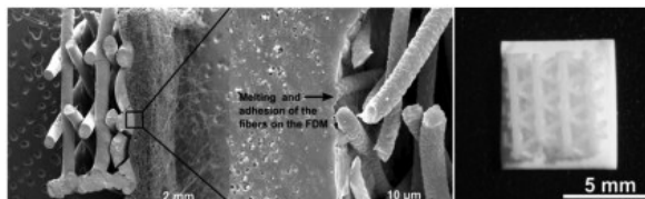
图4 用于牙周再生的双相支架用于骨间室的FDM支架和用于骨间室的电纺膜提供牙周纤维细胞片 [30]
