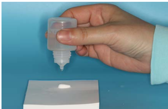
图1 瓶体垂直，瓶口距调和板（纸）2~4cm
